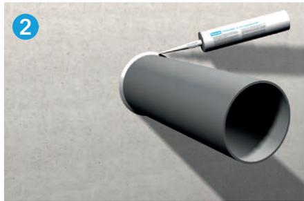
2 Une isolation peut être montée en option. Remplir l'espace annulaire de PROMASEAL®-A et de remplir de laine minérale, de mastic Promat ou de plâtre ou de mortier.
