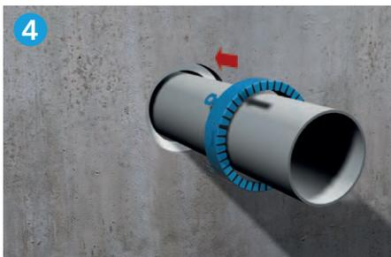
4 Insérer la manchette dans l'ouverture jusqu'à ce que le point extérieur du boîtier métallique soit au même niveau que le paroi/plafond. En cas d'utilisation d'un plafond, la manchette doit être fixée pour éviter qu'elle ne glisse.
