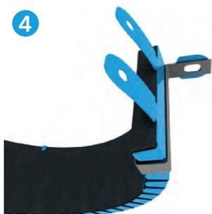
En cas de montage sur le plafond, chaque languette doit être fixée à l'aide d'un clip pour tube oblique. Pour un montage dans le mur, il n'est pas nécessaire d'utiliser un clip pour tube oblique.
