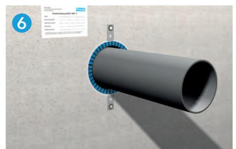
6 La bande métallique est pliée contre la paroi et fixée avec des vis pour cloisons sèches. Placer l'étiquette d'identification à un endroit bien visible
