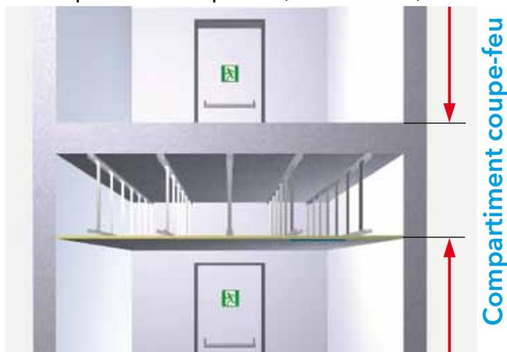
Le faux-plafond est évalué et homologué avec le plafond se trouvant au-dessus. Dans le vide d'air du plafond, aucune installation non présente lors du contrôle ne peut être installée. Le vide d'air du plafond ne représente pas un compartiment coupe-feu en lui-même. L'ensemble plafond/faux-plafond constitue toujours le compartiment coupe-feu.
