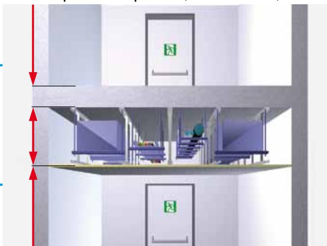
Le sous-plafond indépendant est évalué et homologué comme composant formant un compartiment coupe-feu. Le vide d'air du plafond peut accueillir tout type d'installations. Le vide d'air du plafond forme un compartiment coupe-feu propre. Les installations ne doivent pas exercer une charge sur le plafond en cas d'endommagement.
