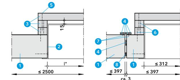
l\* Pour une partie d'installation par élément de plafond: ≤ 1550 mm; poids max. 12,5 kg
