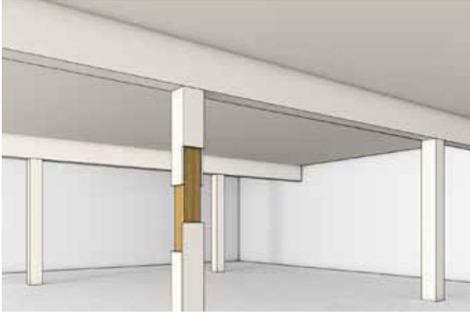
Vor allem bei Sanierungen sind oft Holztragglieder anzutreffen, deren vorhandener Querschnitt allein nicht für einen notwendigen Feuerwiderstand ausreicht. Mit Bekleidungen aus PROMAXON®-Brandschutzbauplatten, Typ A können Stützen für die Feuerwiderstandsklassen R 60, R 90 und R 120 ertüchtigt werden.
