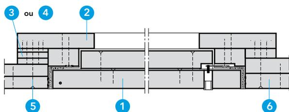
Si nécessaire, installez des profils et des cintres supplémentaires (remplacement)
